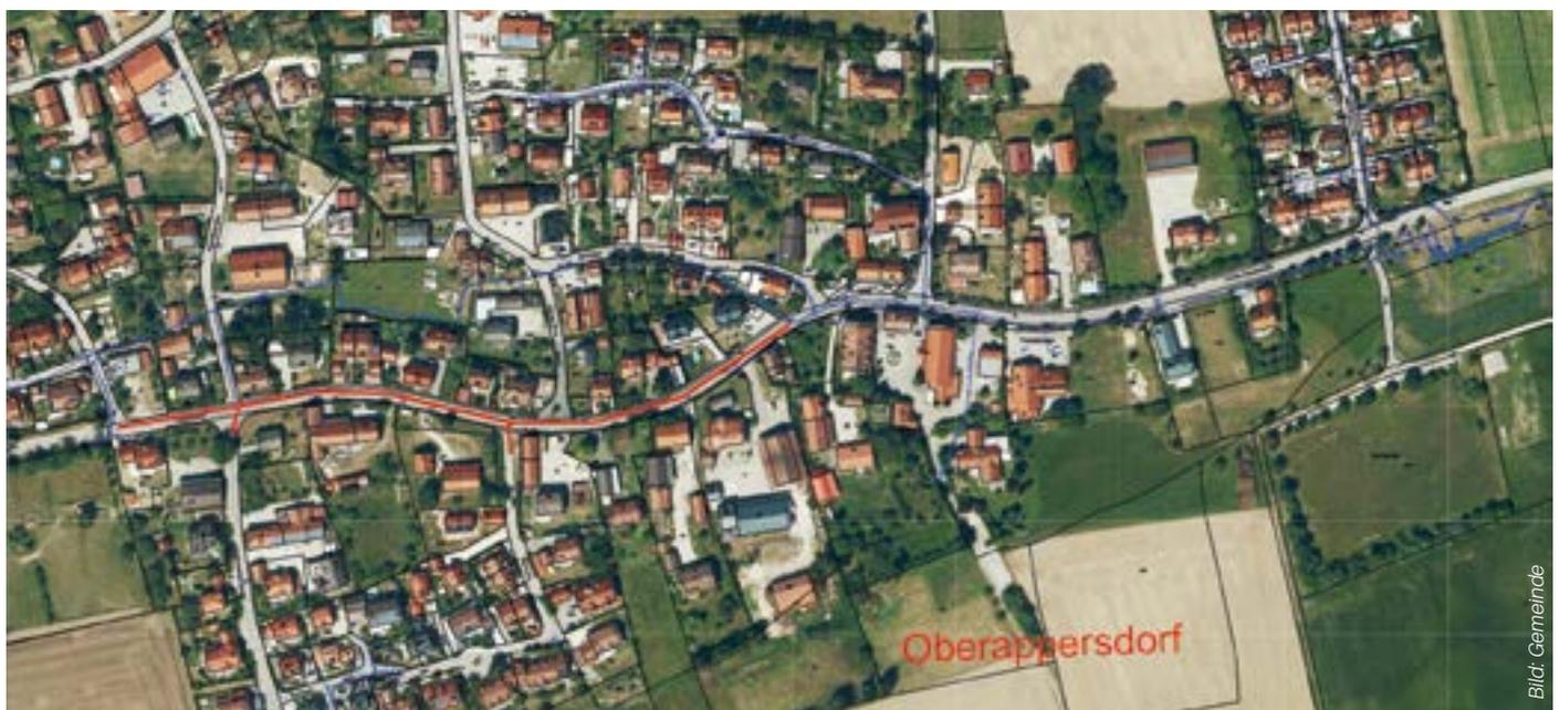
Die rote Linie zeigt das fehlende Teilstück des Regenwasserkanals, das im Zuge der Sanierung der Ortsdurchfahrt neu verlegt wird.
